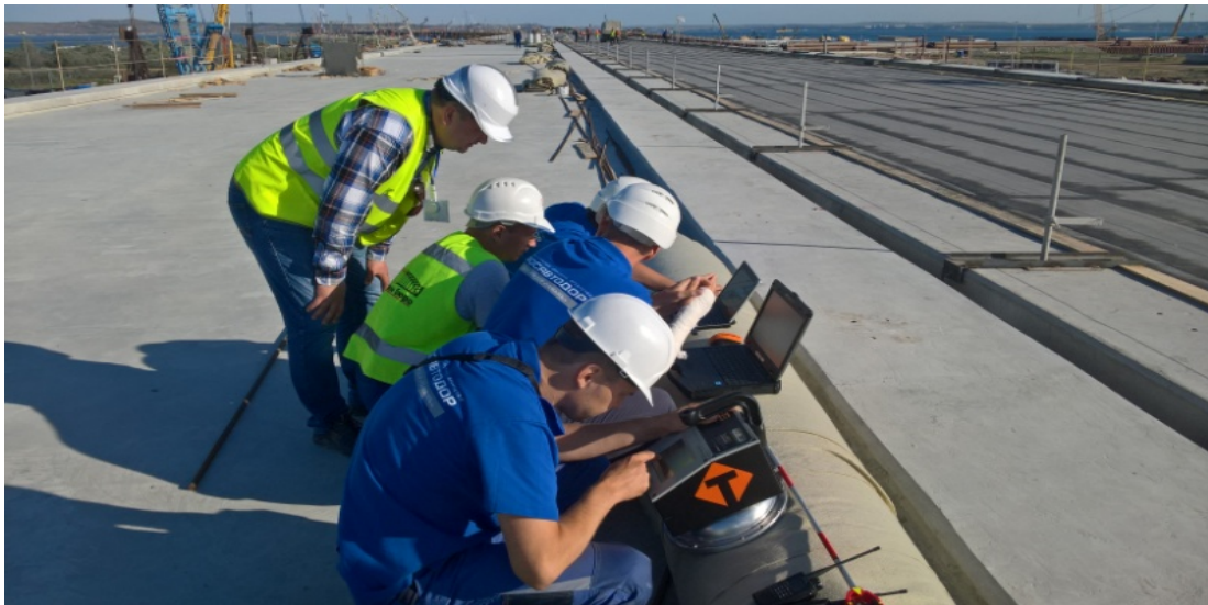
Рис. 4. Камеральная обработка результатов измерений ровности копирной струны
