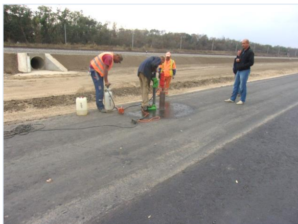
10.2015г. Работы ведёт ООО «Мостовое бюро», ООО УК «Трансжострой», ООО «Интегра». Комиссионный отбор кернов асфальтобетонного покрытия и цементно-грунтового основания притрассовой автодороги ПК42+00 – ПК87+00.
