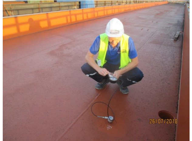
Пролётное строение в осях опор № 85-86 (ж/д мост). Устройство гидроизоляции балластного корыта в осях главных коробчатых балок В-Г. Проведение испытаний по определению адгезии методом отрыва нанесенного грунтовочного слоя. 07.2018
