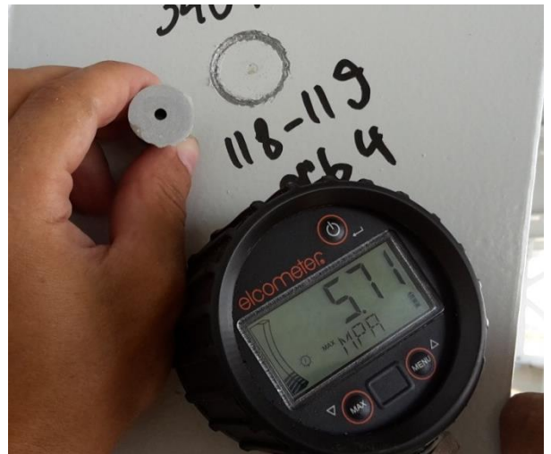
Пролётное строение в осях опор № 85-86 (ж/д мост). Устройство гидроизоляции балластного корыта в осях главных коробчатых балок В-Г. Проведение испытаний по определению адгезии методом отрыва нанесенного грунтовочного слоя. 07.2018
